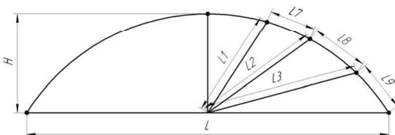
Можно комбинировать замеры из вариантов 1...3. Например, замерять длины  $L4, L5, L6$  и  $L7, L8, L9$  или углы  $a1, a2, a3$  и длины  $L7, L8, L9$ . Таким образом, каждая точка должна иметь две координаты.
